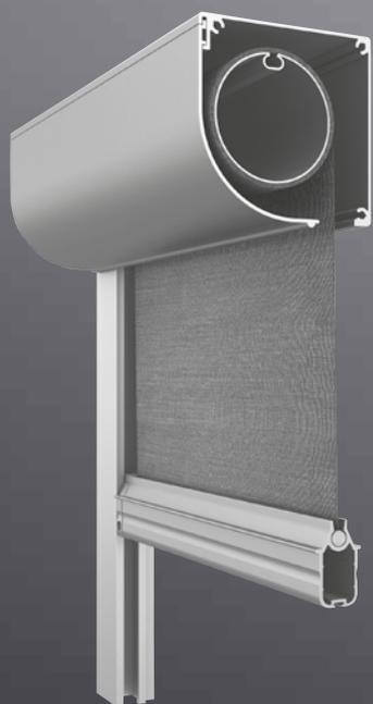
Der RS Classic zeichnet sich durch seine schmalen Führungsschienen aus, so dass es perfekt in kleinen Fensteröffnungen passt. Dieses Reißverschlussystem ist u.a. mit Tüchern aus Glasfaserstoff ausgestattet. Diese Senkrechtmarkise besitzt eine erhöhte Windbeständigkeit, dank des an den Seiten verschweißten Reißverschluss.
